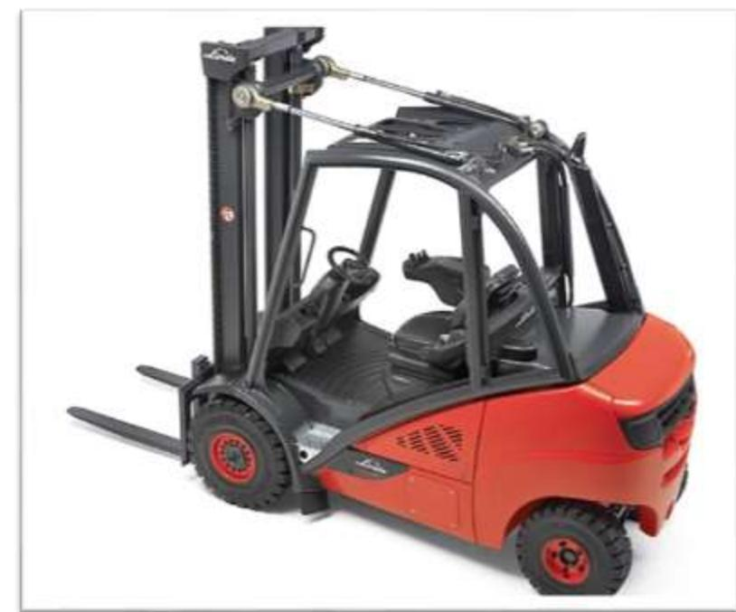
Linde Protector Frame – жесткое и прочное ограждение оператора, являющееся частью несущего каркаса машины. Замкнутая рама оптимально распределяет нагрузку между мостами и образует защищенное со всех сторон рабочее место.
